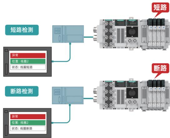
电磁阀短路断路检测
