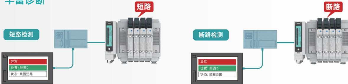
电磁阀短路断路检测
