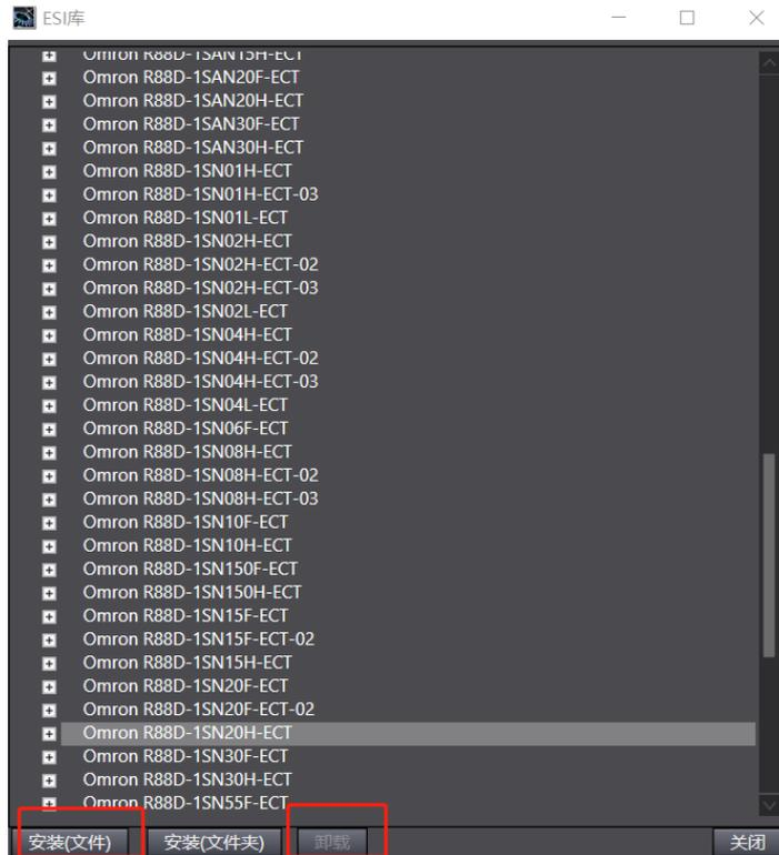
图 5-3-2 安装与卸载 XML 文件
