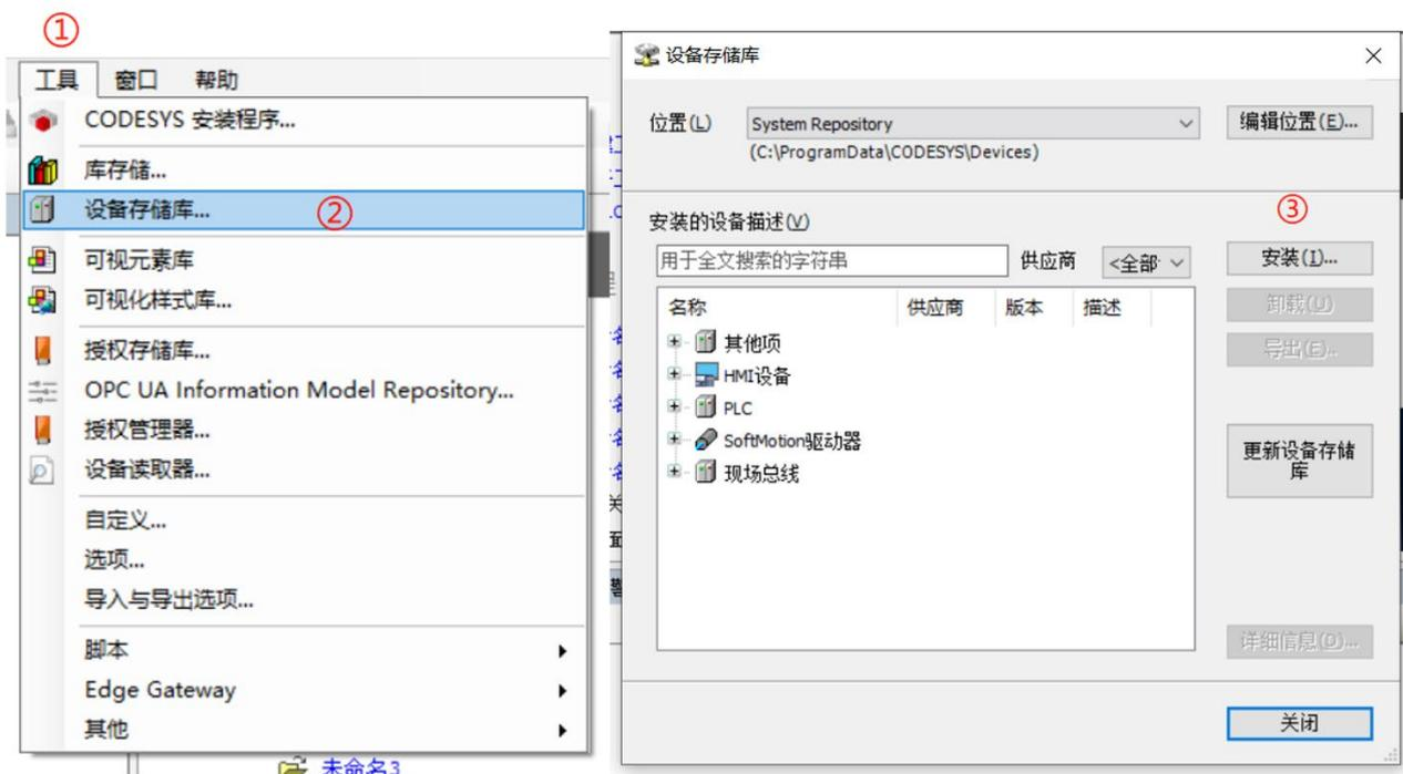
图 5-2-2 安装 XML 文件
