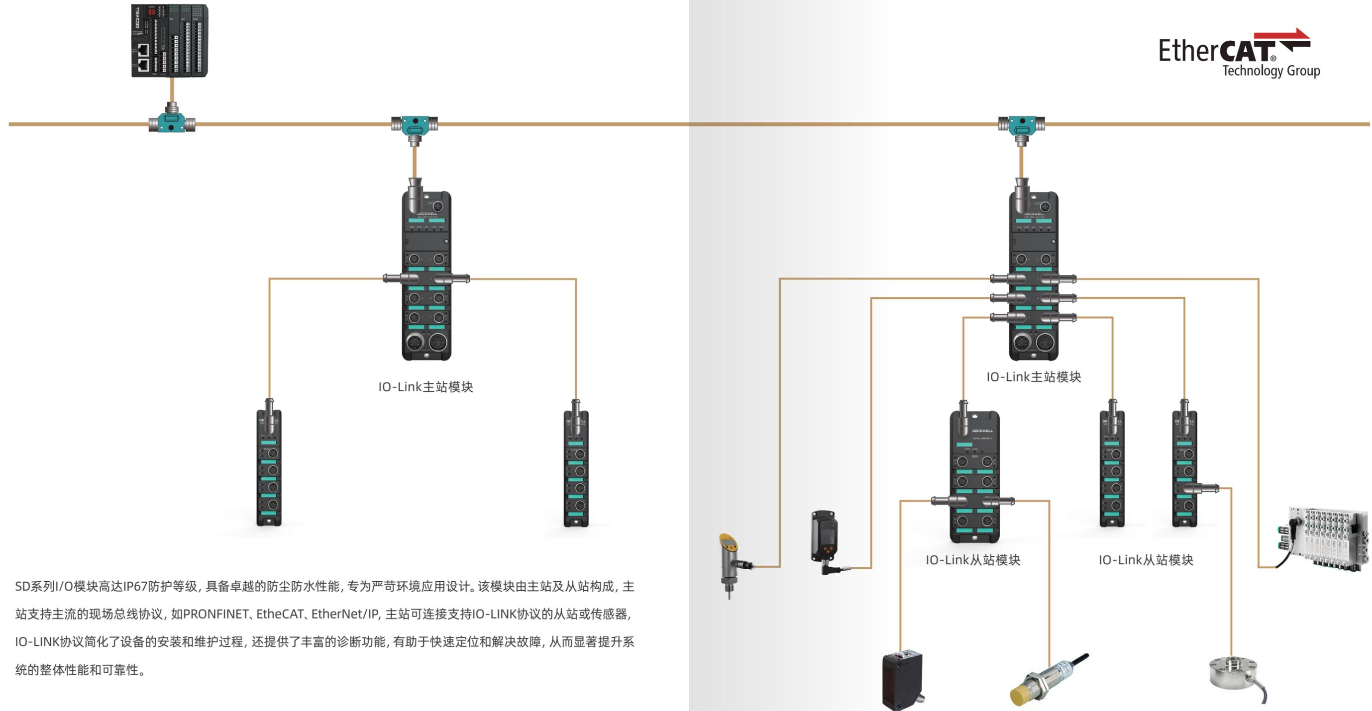
SD系列I/O模块高达IP67防护等级, 具备卓越的防尘防水性能, 专为严苛环境应用设计。该模块由主站及从站构成, 主站支持主流的现场总线协议, 如PRONFINET、EtheCAT、EtherNet/IP, 主站可连接支持IO-LINK协议的从站或传感器, IO-LINK协议简化了设备的安装和维护过程, 还提供了丰富的诊断功能, 有助于快速定位和解决故障, 从而显著提升系统的整体性能和可靠性。
