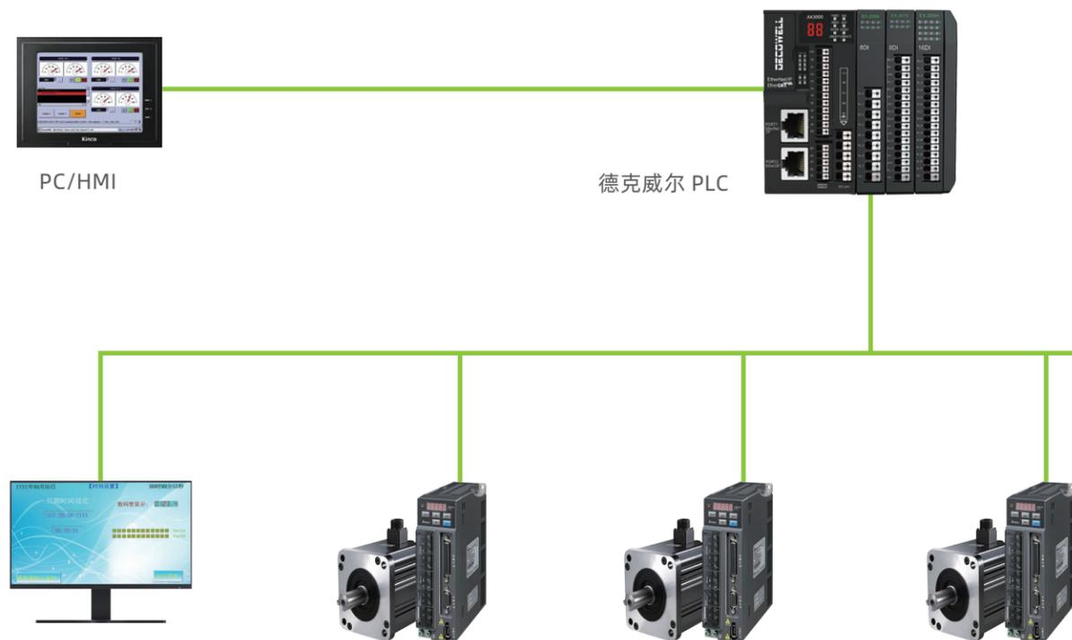
FS系列一体式I/O是德克威尔最经典的一体式总线I/O模块, 拥有性价比高、性能稳定, 结构紧凑、接线简单等特点。支持多种通讯协议, 如PROFINET、EtherCAT、DeviceNet、CC-Link、EtherNet/IP、CANopen、CC-LINK IE Field Basic等。单个模块最大支持32个信号点。以太网通讯接口斜45度设计, 可减少网线长期弯折对网口结构造成的应力, 系统的可靠性更佳。所有端子均采用PUSH-IN的接线端子, 极大的减少现场安装接线的工作量节约安装时间。
