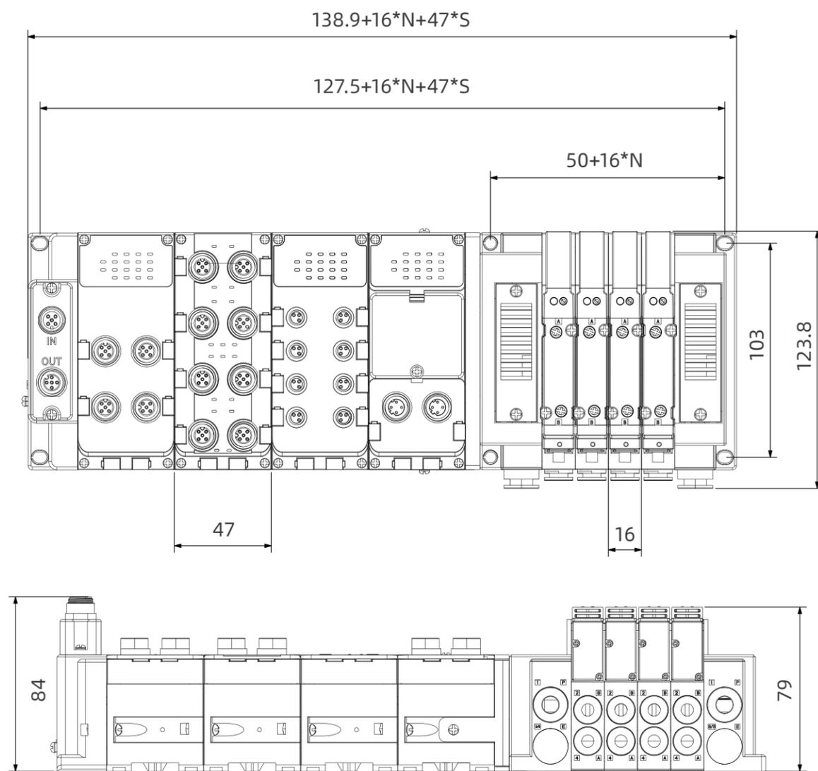
搭配 M12 电源阀岛尺寸图
