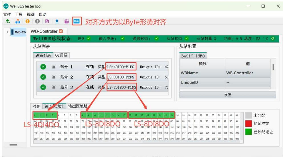
**Bit 型对齐方式:** 下图是以 Bit 为最小单位对齐方式:LS-4DI4D0 输入地址占 4 个 Bit, 地址从 0-3, 后面的从站地址就依次往下排, 第二个从站为 LS-8DI8D0, 输入区占 8 个 Bit, 地址为 4-13, 后面从站 IO 地址按照实际占用数量依次排布。
