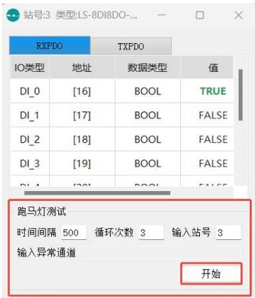
在强制模式下，在跑马灯测试界面点击“开始”按钮，模块的输出指示灯将依次点亮，可通过设置时间间隔和循环次数改变效果
