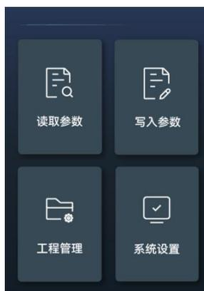
触摸屏幕进入到读取参数界面。手持设备红外窗口对准从站红外窗口，距离在 10cm 以内，点击屏幕中的读取按钮实现读取从站参数功能。
