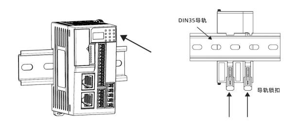
说明:模块安装完成后,需用手向上按压锁扣顶部,保证安装到位。
