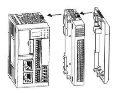
模块采用 DIN 导轨安装, DIN 导轨需符合 IEC 60715 标准 (35mm 宽, 1mm 厚), 尺寸信息。
